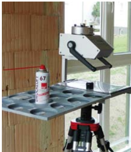
Nach der erfolgten Sanierung wurde eine sogenannte Freimessung als Erfolgskontrolle der Sanierung ausgeführt.
